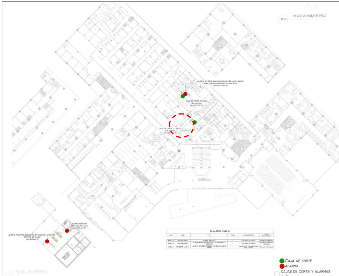
Imagen 17: Ubicación de caja de corte sin alarma de área-Nivel 01 ala Central Fuente: Propia
